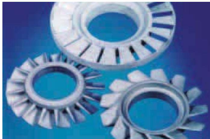
Im DMLS-Prozess gefertigte Funktionsprototypen (Leiträder von Drehmomentwandlern). Aufnahme: LFT
