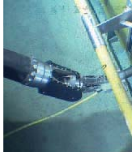
Abb. 5: Der Roboterarm der Nautilé versucht, die Verbindung zwischen einem „string“ und der zentralen „junction box“ herzustellen.
