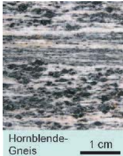
Abb. 1: Polierter Anschnitt eines Hornblende-Gneises mit lagenweise angeordneten grünen Hornblende-Kristallen.
