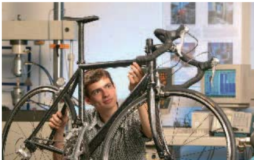
Der Maschinenbaustudent Karl Durst mit seinem selbst gebauten Fahrradrahmen aus carbonfaserverstärktem Kunststoff. Mit allen Aufbauten wiegt das Rad nur 6,8 Kilogramm. Foto: Kurt Fuchs
