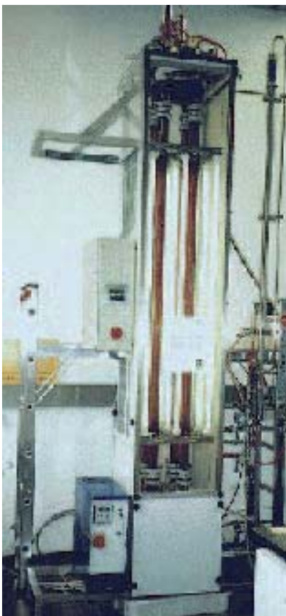
Im Reaktor „Medusa“ wachsen winzige, aber leistungsfähige Meeresalgen heran. Sie produzieren Wirkstoffe, die auf neuartige Medikamente gegen Viren hoffen lassen.
