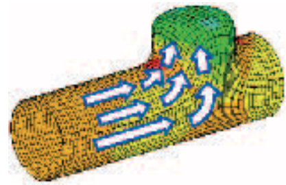
Abb. 2: Schematische Darstellung der Effekte der Strömung einer hochviskosen Flüssigkeit beim Innenhochdruck-Umformen von Rohren. Abbildungen: LFT
