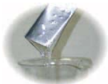
Abb. 1: Hochviskoses Verhalten des Mediums, das im Umformprozess eingesetzt wird.
